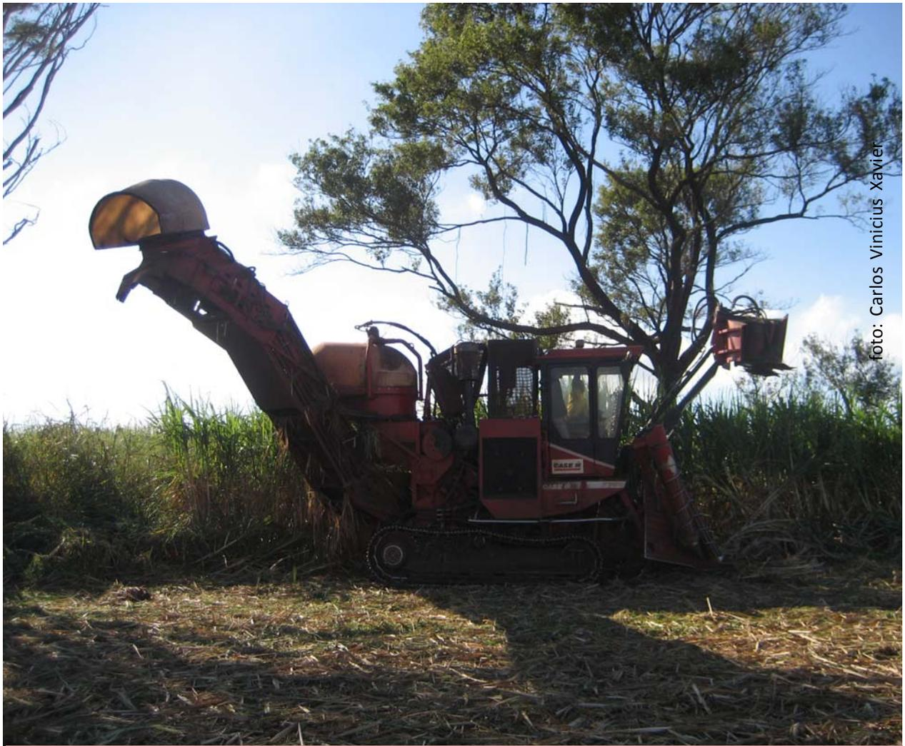
**Foto 06:** Máquina utilizada para o corte mecânico de cana crua. Região de Andradina/SP.
